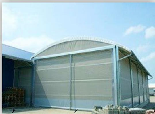
Ворота с двойным наматыванием WST11 скручиваются с помощью двух приводных валов. Благодаря этому ветрозащитная площадь состоит из 4 частей, что позволяет увеличить расстояние между стойками – опорами. Как для односекционных ворот, так и для ворот, состоящих из нескольких секций можно устанавливать передвижные (мобильные) опоры.
